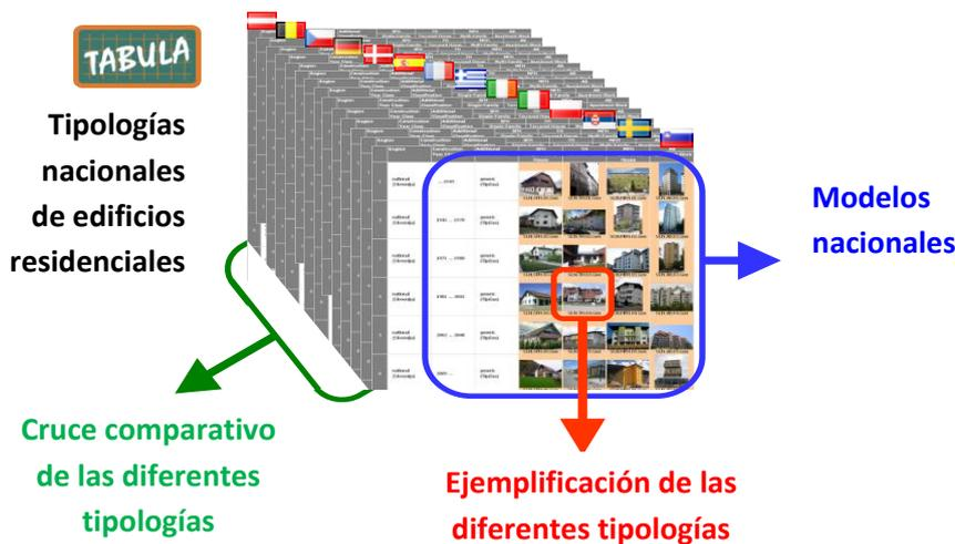
A través de la "Matriz de tipos de edificio" podemos obtener una visión general de la clasificación tipológica de edificios de un país. Las columnas de la matriz representan cuatro escalas de tamaño de edificio y las filas representan los diferentes períodos de construcción. Los períodos de construcción son diferentes en cada país. Las celdas individuales de la matriz constituyen los "tipos de edificio" de un país.
